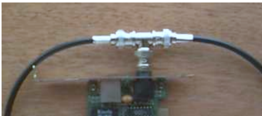
Conector T na placa de rede
